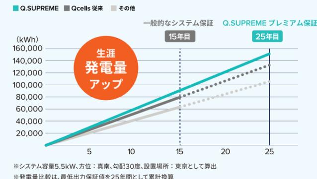
※システム容量5.5kW、方位：真南、勾配30度、設置場所：東京として算出
