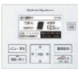
ハイブリッド蓄電用リモコン
