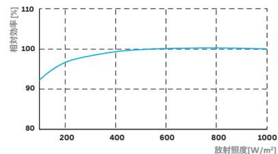
標準テスト条件(STC:1000W/m<sup>2</sup>、25°C)との比較した際の
