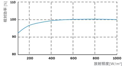
標準テスト条件(STC:1000W/m<sup>2</sup>、25° C)との比較した際の低照度条件下での標準的なモジュール性能。
